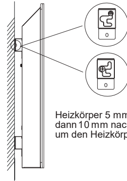
Den Heizkörper von der Wand nehmen
