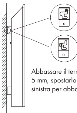
Rimuovere il termoconvettore dalla parete
