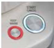
Die Taste »KEEP WARM« dient zum Warmhalten des Wassers. Wenn z.B. die 100° Taste ausgewählt und die Temperatur erreicht ist, wird das Wasser bis zu 20 Minuten auf ca. 95°C warm gehalten. Um die Warmhaltefunktion zu aktivieren, wählen Sie das gewünschte Temperaturprogramm, drücken anschließend die »KEEP WARM«-Taste und danach die »START«-Taste. Der Kochvorgang beginnt. Sie können die »KEEP WARM«-Taste auch während oder eine Minute nach dem Kochvorgang betätigen.
